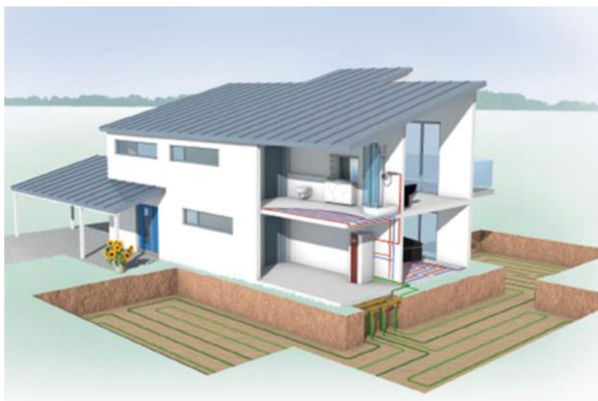
Rys. 7. Pompa ciepła z gruntowym poziomym wymiennikiem ciepła.
