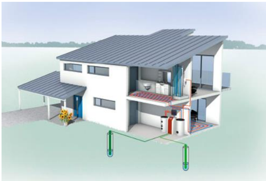
Rys.1. Pompa ciepła z ciekim wodnym jako dolnym źródłem ciepła. Źródło; DIMPLEX „Innowacyjne grzanie i chłodzenie” [2].
